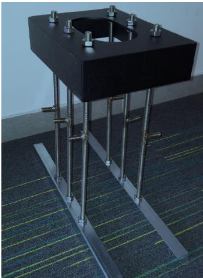
Slika 4: Sestavljen podzemni sidrni element
