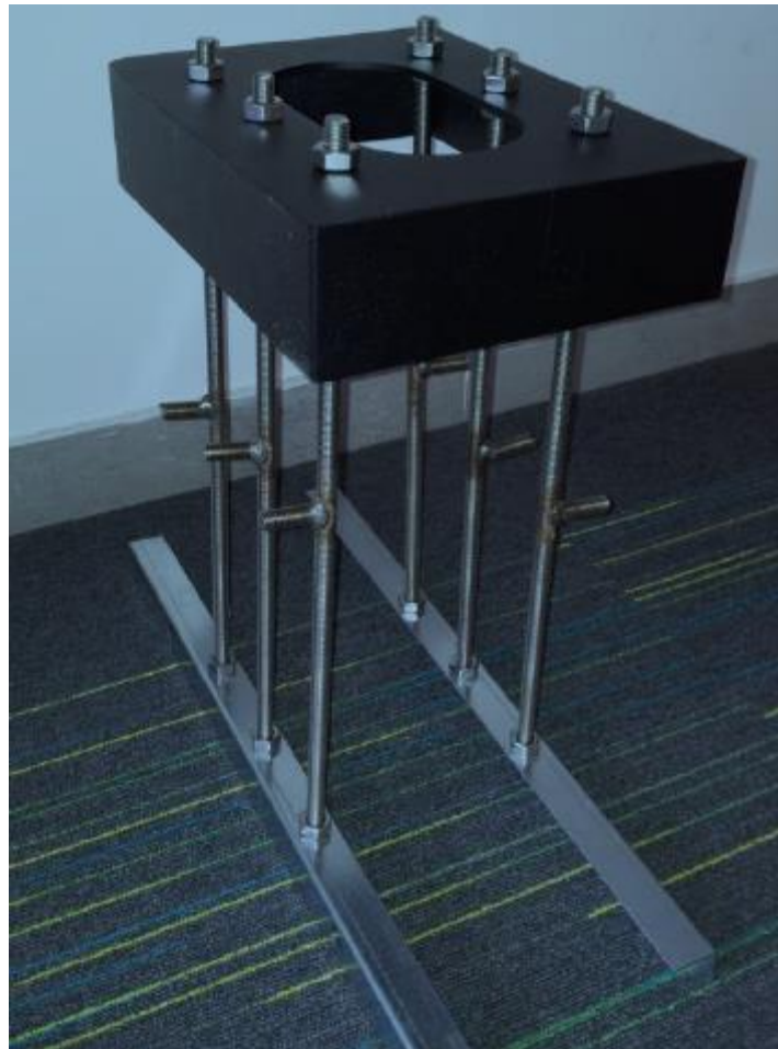
Figura 4: elemento di ancoraggio interrato assemblato
