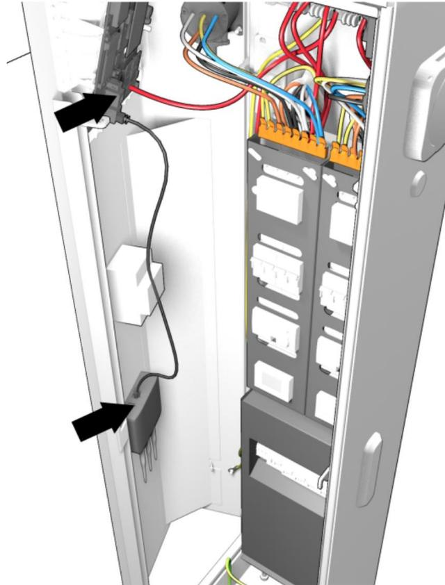
Figura 20: collegamento dei cavi UTP
