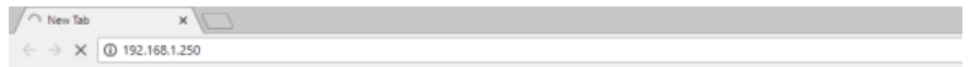
Afbeelding 22: Voer het standaard IP-adres in de browser in om verbinding te maken met de web-interface
