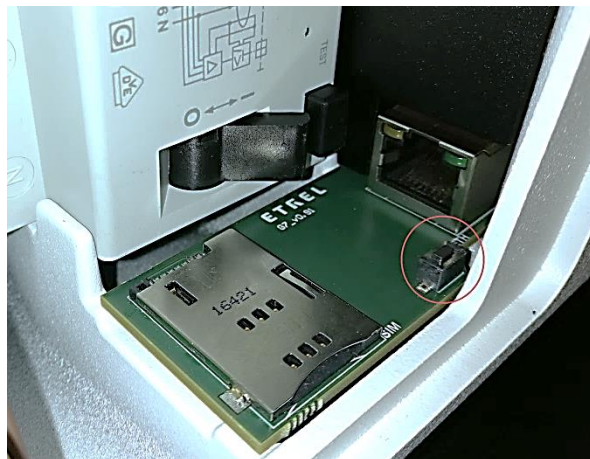
Afbeelding 43: Resetknop in de onderhoudsopening
