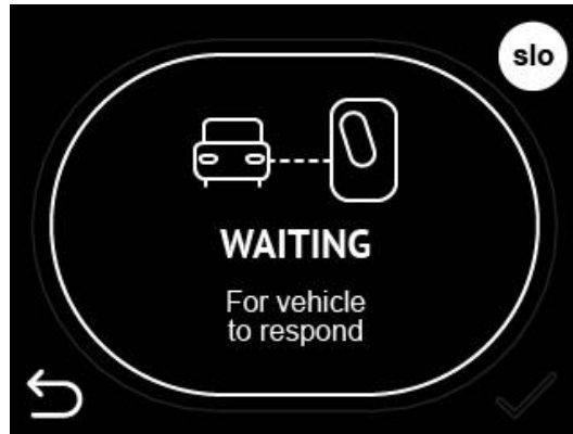
Afbeelding 16: Het laadstation wacht totdat het elektrische voertuig reageert en begint met opladen
