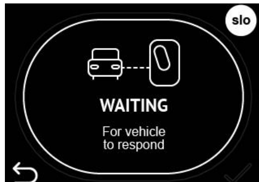
Figure 16: La station de charge attend que le véhicule électrique réponde pour commencer à charger
