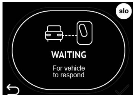
Kuva 16: Latausasema odottaa sähköauton vastausta ja latauksen aloittamista
