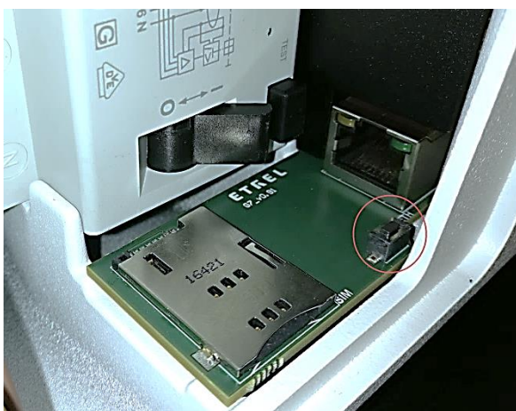
Kuva 43: Huoltoaukon sisällä oleva nollauspainike
