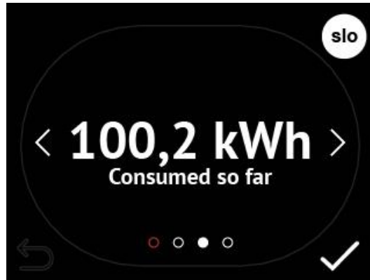
Kuva 18: Esimerkki nestekidenäytön energiankulutuksen näytävästä näytöstä
