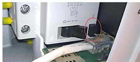
Figura 34: Botón de prueba de RCD
