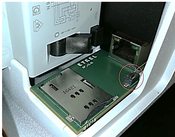
Abbildung 44: Reset-Knopf in der Wartungsöffnung
