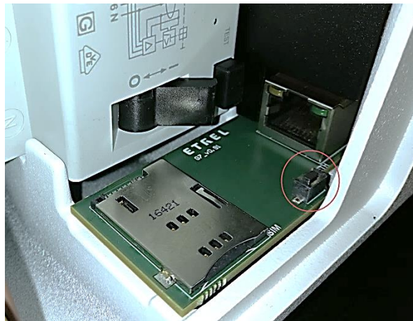
Figura 44: Pulsante di reset all'interno dell'apertura di manutenzione
