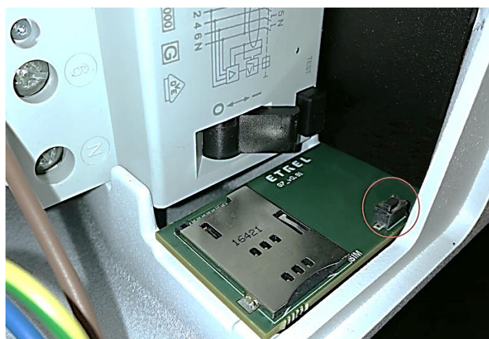
Figur 8: Återställningsknapp inuti underhållsöppningen
