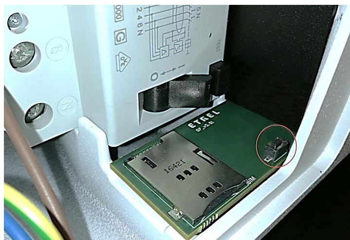
Slika 8: Gumb za ponovno postavljanje unutar otvora za održavanje
