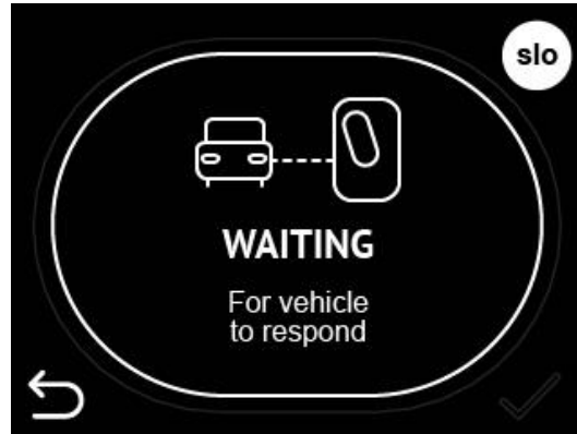
Figura 7: La estación de carga está esperando que el VE responda y comience a cargar
