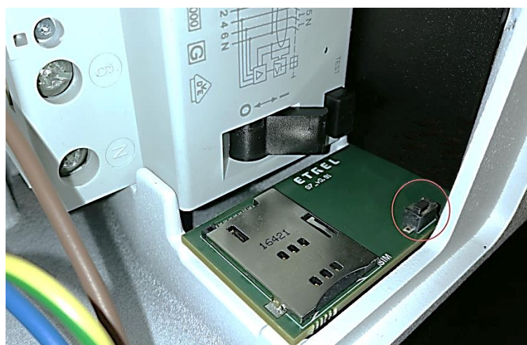
Abbildung 14: Reset-Taste in der Wartungsöffnung
